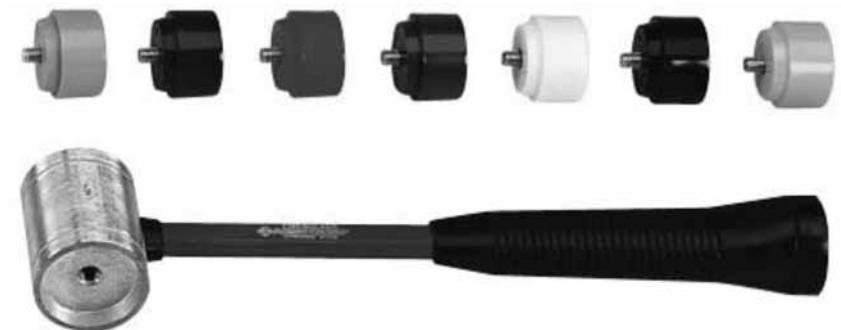
Figura 126. Martillo de cara suave, con caras intercambiables de distinta dureza.
