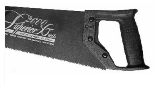
Figura 90. Mango de serrucho, donde se observa la forma oval de la empuñadura, superficie antideslizante, (mango), bordes redondeados, espacio para guía del índice (Sandvik).
