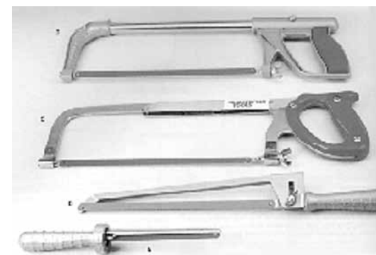
Figura 91. Distintos tipos de sierras: (A) sierra para cortes a partir de una perforación; (B) sierra para espacios reducidos; (C) y (D) sierras con mango convencional (Armstrong Tools).
