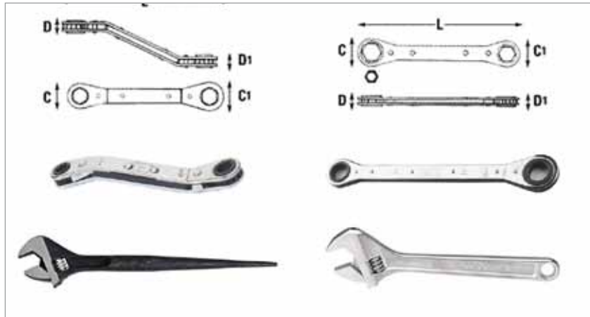
Figura 115. Llaves móviles y de cricue (matracas). Abajo a la izquierda, llave ajustable con cola (apta para centrar agujeros en montajes y evitar llevar una punta); abajo a la derecha, llave ajustable (francesa); arriba, llaves matraca para cañerías (evitan el uso de dos llaves de boca o tener que colocar y sacar las llaves luego de cada giro).
