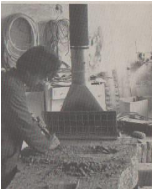
Figura 97 Cincelando sobre un banco de trabajo con extractor
