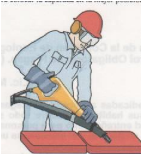
Figura 310. Martillo cincel con extracción de polvos
