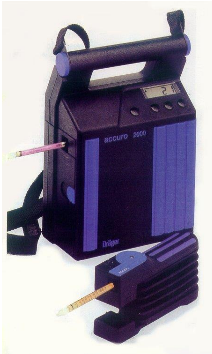
Figura 165. Bomba portátil manual y bomba automática
