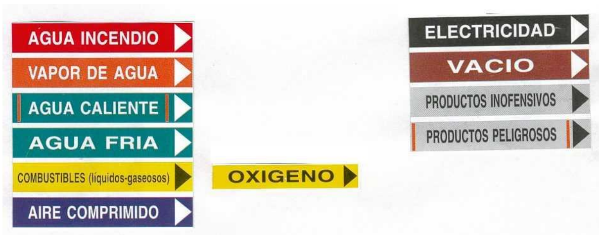
Figura 13.132. : Colores de identificación de cañerías (firma Produseg. SRL.)
