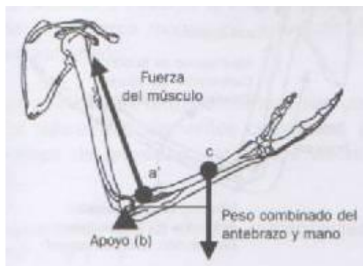
Figura 7.19 Palanca de tercer orden (Manual Ergonomía y psicológica de D. González Maestre)
