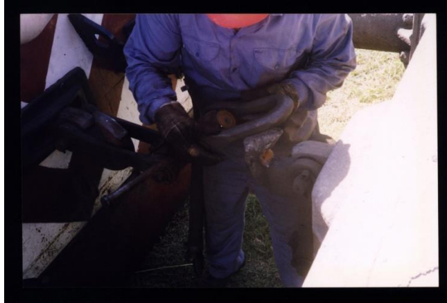
Figura 2.1. Factibilidad. No es posible enganchar los dos vagones ya que están demasiado distanciados.
