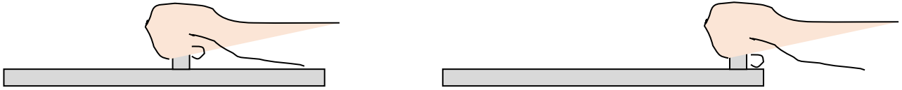
Figura D2 Al abrirse la puerta de la izquierda y quedar trabada la mano la persona puede fracturarse, esto no ocurre en la puerta de la derecha
