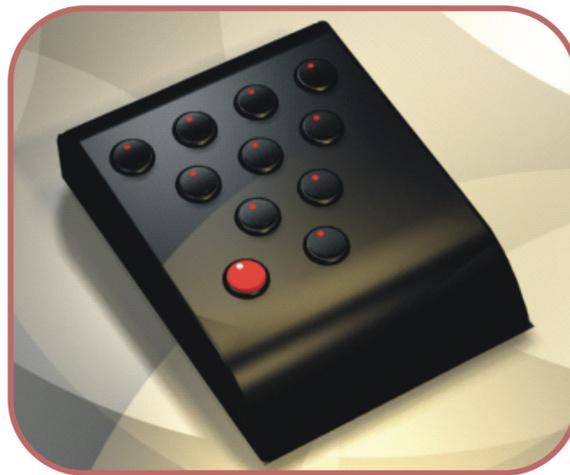
El dispositivo de entrada contiene información visual necesaria y suficiente dispuesta para ser entendida por el guía y generar una transducción del estímulo al sistema de codificación en umbrales (Vibraciones) perceptibles por el invidente.
