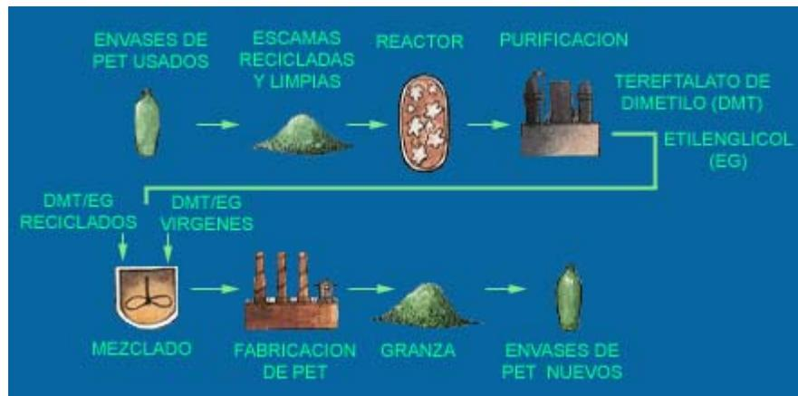
Fig. 1. El proceso de Metanolisis tomado de <http://www.aprepet.org.mx/index2.htm>
