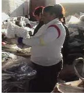
Figura 3. Estación 2: Selección y clasificación de material plástico.
