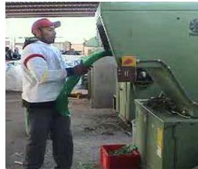
Figura 8. Estación 7. Molido de mangueras.
